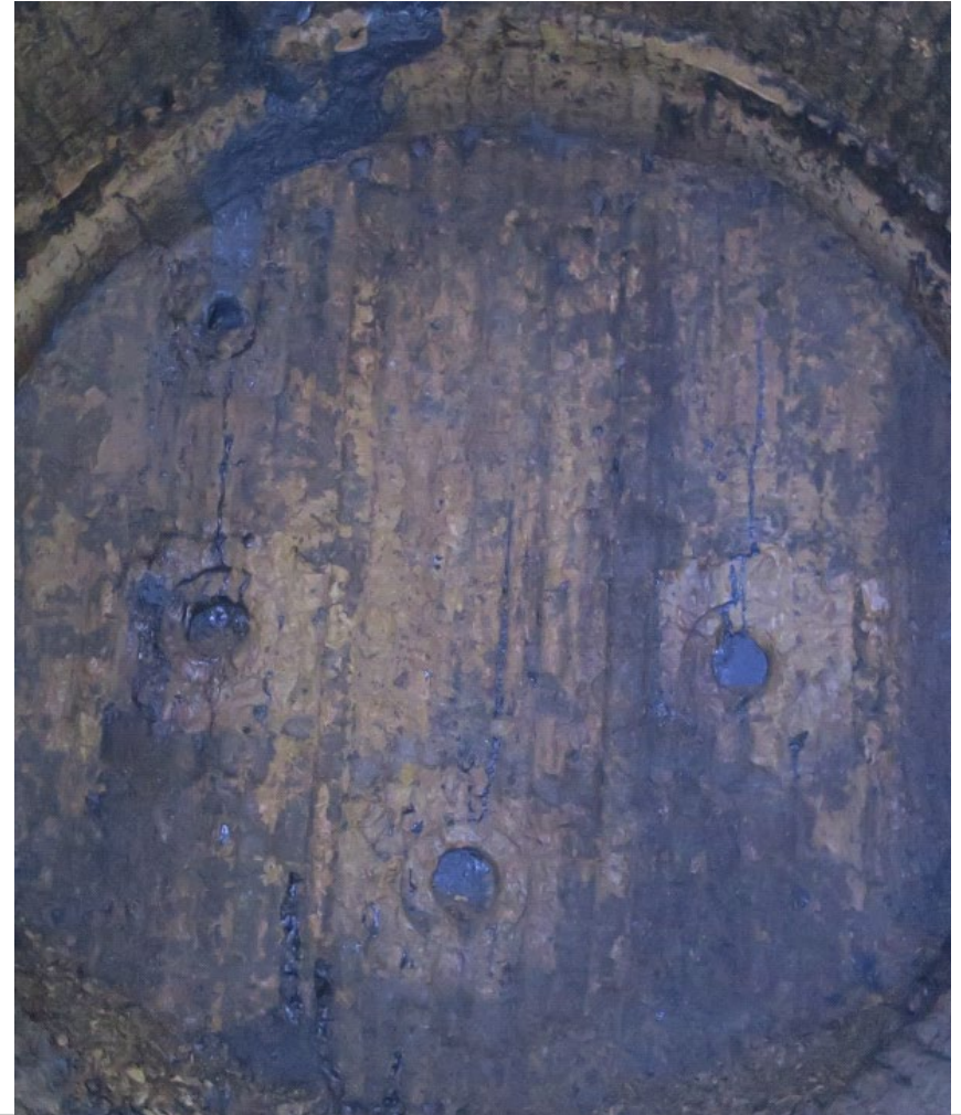
Aussehen Pfannenboden nach Aussetzen (Reise 99, 63 Abgüsse)
